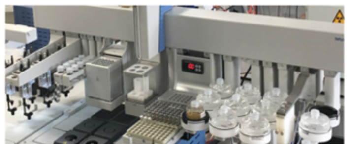
รูปที่ 1 ขั้นตอนการเตรียมตัวอย่างด้วยเครื่องฉีดสารอัตโนมัติ และเครื่องมือที่ใช้ในการเตรียมตัวอย่างอัตโนมัติ
