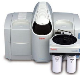
รูปที่ 1 แสดงเครื่อง iCE3400 Graphite furnace AAs ผลิตภัณฑ์ Thermo Scientific ประเทศสหรัฐอเมริกา
